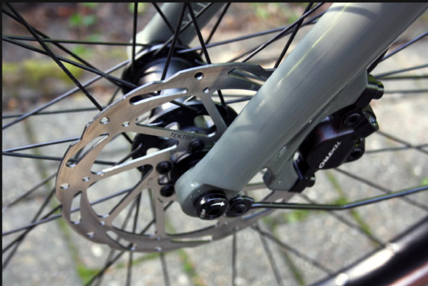
Die Tektro-Stopper verrichten ihre Verzögerungsarbeit so wie man es von modernen Scheibenbremsen erwarten darf Foto: Yuccie Junico Flow Gent
