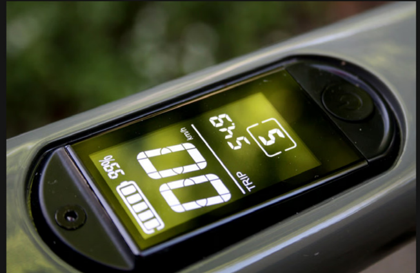
Das kleine monochrome Anzeigedisplay für den E-Antrieb befindet sich im Oberrohr Foto: Yuccie Junico Flow Gent
